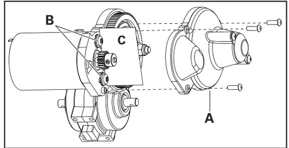
3. Avvicinare i due ingranaggi stringendo le viti del motore.
