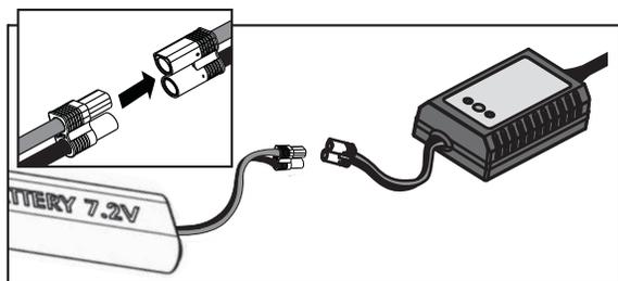
Il caricabatterie per la batteria del motore ha una corrente di carica di 2000 mAh (2 Ah). Dividendo la capacità in mAh indicata sull'etichetta della batteria per 2000, si ottiene il tempo necessario alla sua carica. Per esempio una batteria scarica da 1800 mAh richiede circa 0,9 ore (54 min.) per la ricarica.
