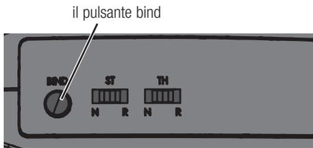
4. Rilasciare il pulsante "bind" quando il LED verde lampeggia. Mantenere il volantino e il grilletto nella posizione di failsafe finché la luce del LED sul ricevitore non diventa fissa.
